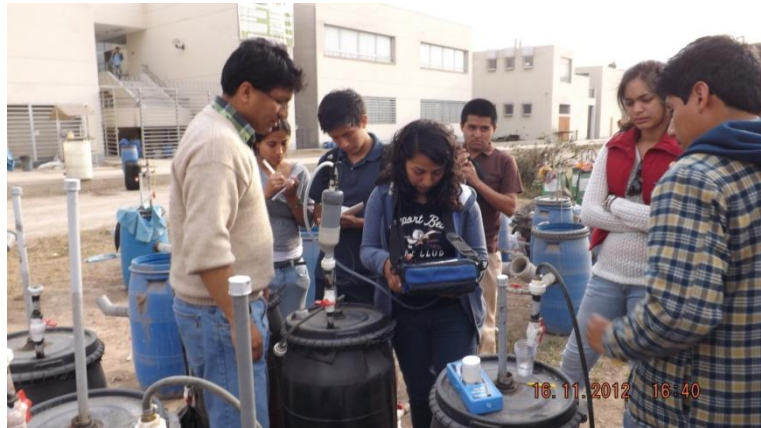
Foto 5. Monitoreo de la calidad de biogás con el equipo de medición de metano en los reactores
