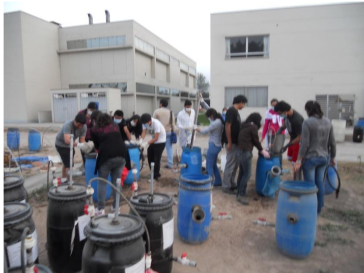
Foto 4. Cargado en los reactores instalados en el Laboratorio de ingeniería Ambiental -UNALM
