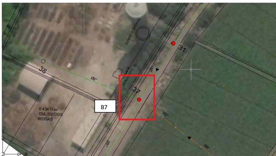
Una vez identificados los buzones que forman parte de la conducción de A.R.D. se procedió a establecer un perfil de la conducción con la ayuda de equipos topográficos. A continuación se muestra el plano resultado que es adjuntado bajo el código de "PC-002".
